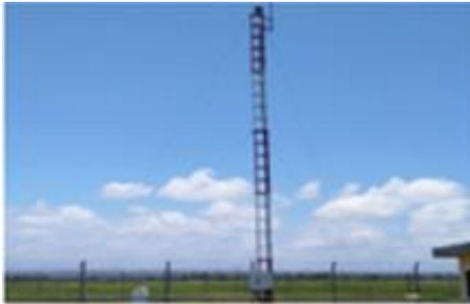
Merupakan peralatan atau system terpadu yang di desain untuk mengumpulkan data cuaca secara otomatis serta di proses agar pengamatan menjadi lebih mudah
