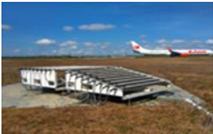
Merupakan peralatan canggih digital yang memberikan profil awan dan pergerakan kecepatan angin pada lapisan atas pada satu titik vertikal
